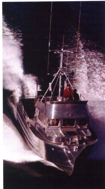
Рис. 2. Канадское быстроходное рыболовное судно с корпусом из легких сплавов
