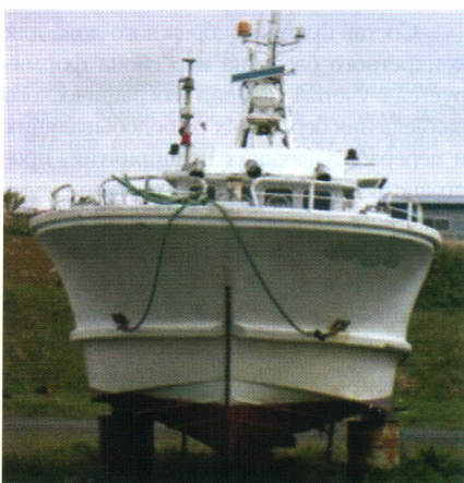
Рис. 6. Носовая часть обводов быстрого промыслового судна японской постройки
