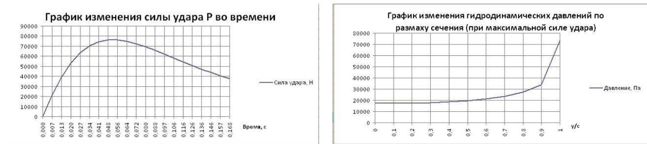
**Рис. 2. Результаты расчетов ударных нагрузок, действующих на СПК**
