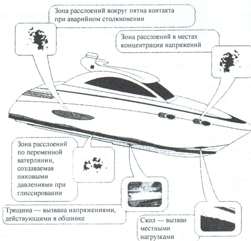
Рис. 3. Расположение дефектов эксплуатационной природы на корпусе судна из КМ
