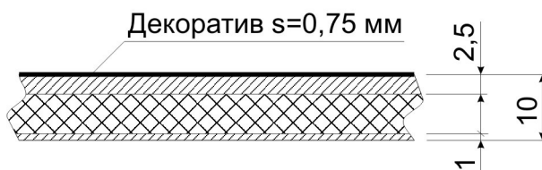
Рис. 3. Сечение обшивки палубы с подкреплением из вспененного заполнителя
