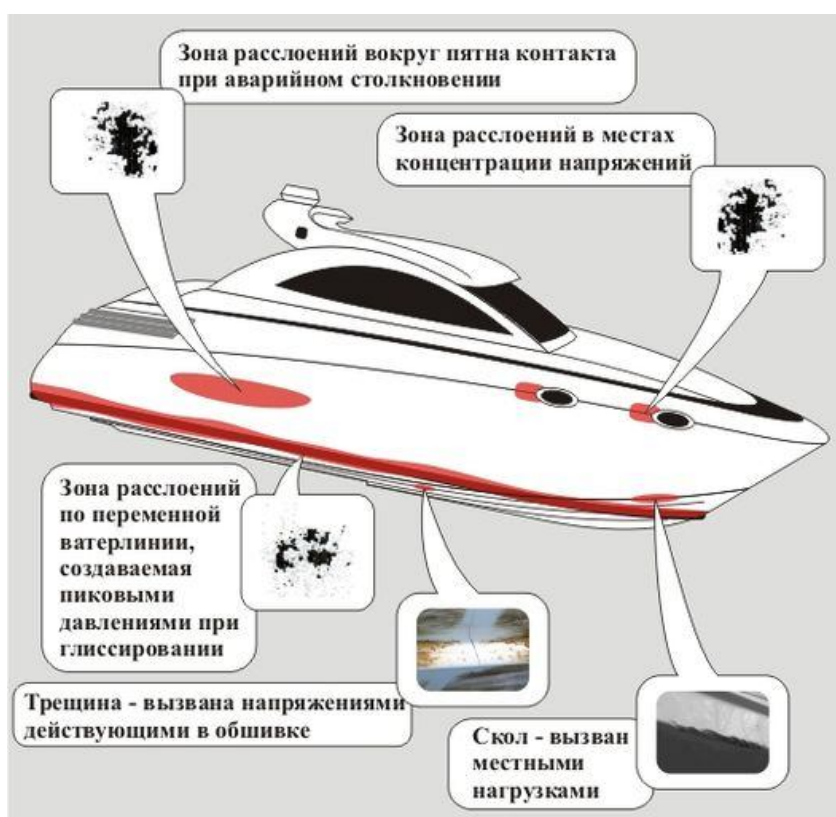
Рис. 7. Расположение дефектов эксплуатационной природы на корпусе судна из композиционных материалов.
