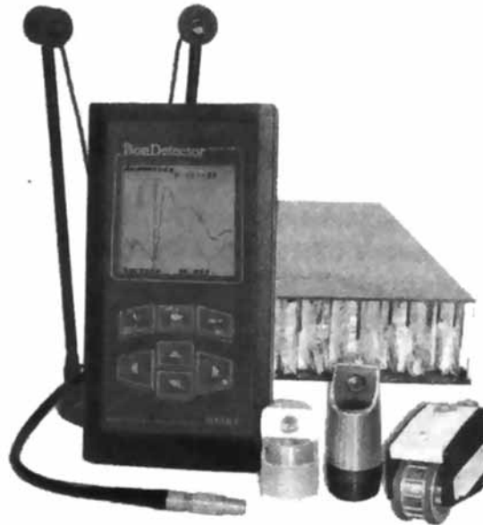
Рис. 3. Портативный дефектоскоп ДАМИ-С.
