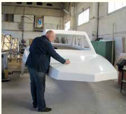
Рис. 10. Дефектоскопия надстройки СПК из композитов
