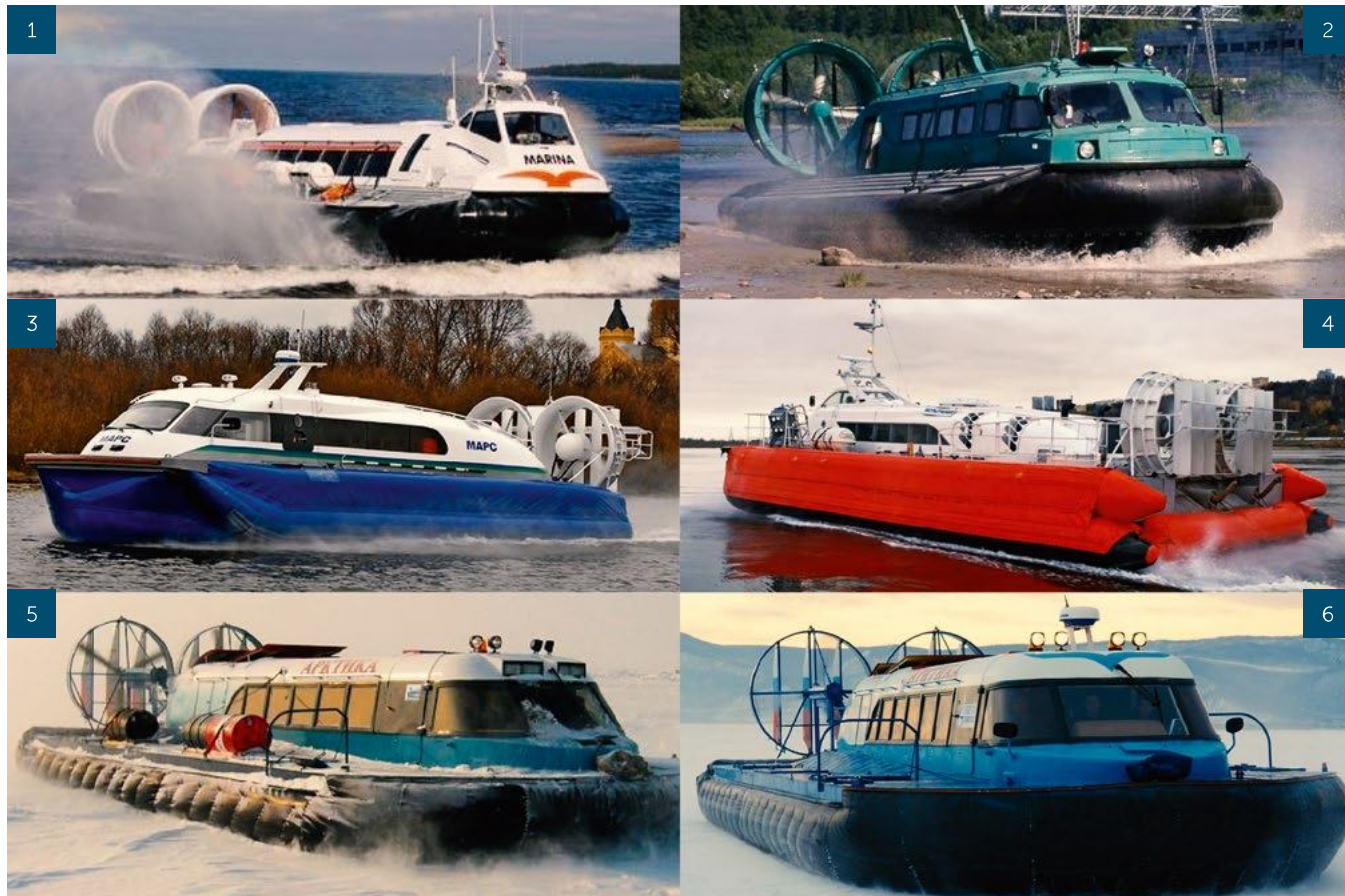
Рисунок 1. Амфибийные суда на воздушной подушке, имеющие корпус из легких сплавов и надстройку из композитов: 1 — АСВП «Ирбис», 2 — «Пума», 3 — МАРС 2000, 4 — МАРС 3000, 5 — АРКТИКА, 6 — АРКТИКА 4Д.
